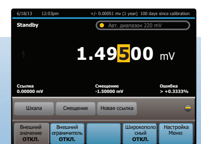
Клавиши OFFSET и SCALE позволяют легко компенсировать ошибки смещения нуля и шкалы и непосредственно отобразить ошибки линейности при любом масштабе.
